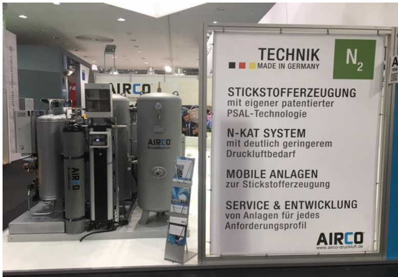
Skitplattform mit PSAL-Anlage
